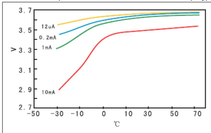
Зависимость емкости элемента питания от тока разряда и температуры элемента питания:
