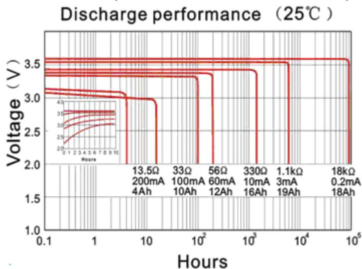
Зависимость напряжения на элементе питания от температуры элемента питания и тока разряда:
