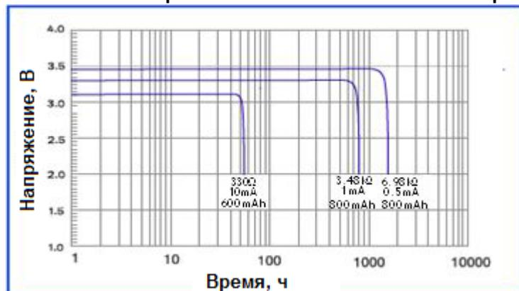
Зависимость напряжения на элементе питания от температуры элемента питания и тока разряда:
