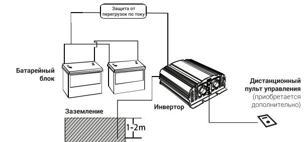
Рисунок 6.2: Подключение инверторов KV-M1000/KV-M1500/KV-M2000/KV-M2500/KV-P1000/KV-P1500/KV-P2000/KV-P3000
